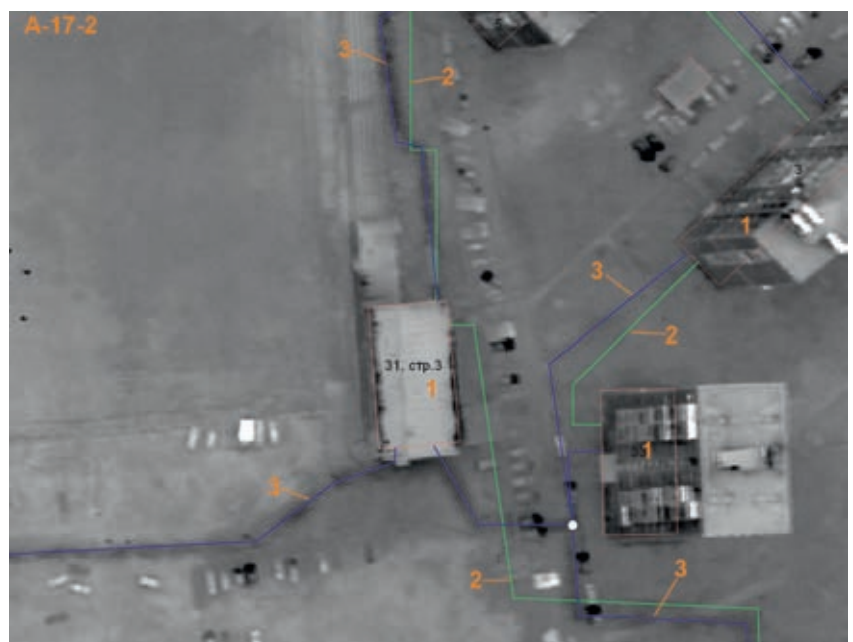
Рис. 3. Пример уточнения планового положения теплосетей Москва, осень 2009 года, ночь, негатив
