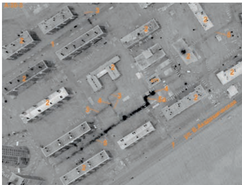
Рис. 2. Характер проявления утечки на теплотрассе среднего диаметра, выявленной в процессе экспресс-диагностики.
