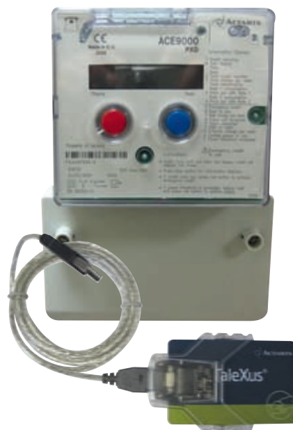
Приборы, входящие в концепцию авансовых платежей за энергоресурсы (IMTC) а) счетчик; б) карт-ридер со смарт-картой
