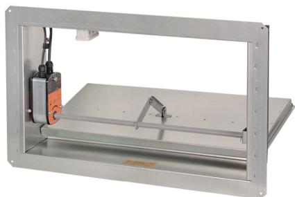
Противопожарными НЗ клапанами являются клапаны КЛАД®-3. НЗ клапаны применяются в системах как вытяжной, так и приточной ПВ независимо от типа защищаемого помещения и способа их монтажа. Предел огнестойкости клапанов КЛАД®-3 – Е1 120, что позволяет их применять в любых системах вытяжной и приточной противодымной вентиляции. В отличие от клапанов КЛАД®-2 заслонка стеновых и канальных клапанов КЛАД®-3 заполнена термоизоляцией.
