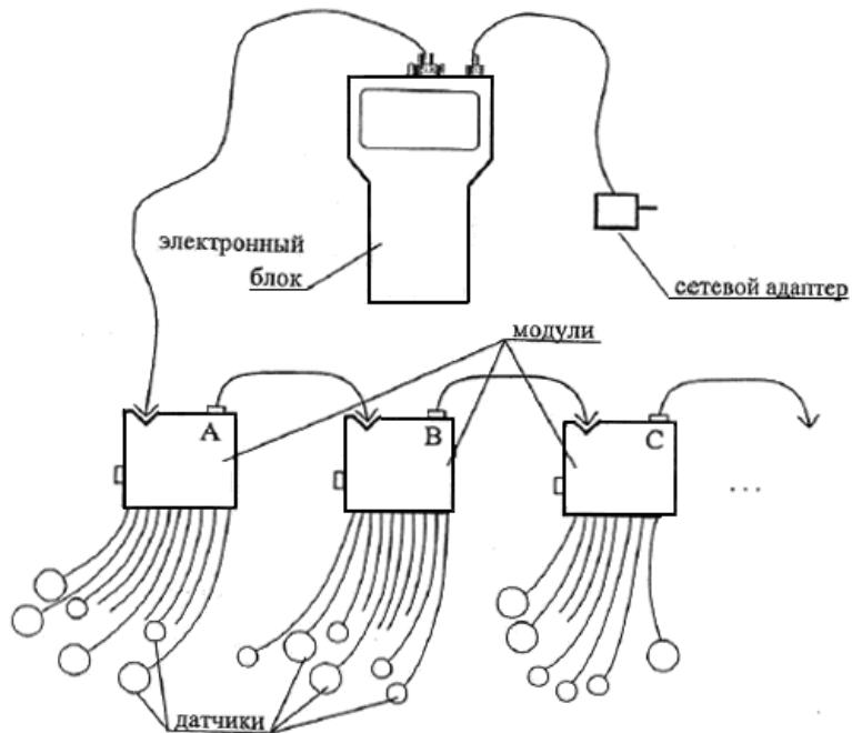
Рисунок А.1 - Схема кабельных присоединений преобразователей теплового потока и датчиков температуры измерителя ИПП-МГ 4.03 "Поток"
