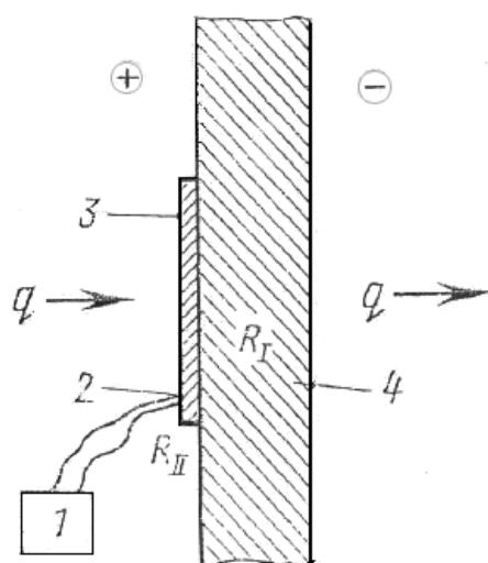
1 - измерительный прибор (потенциометр постоянного тока по ГОСТ 9245);
