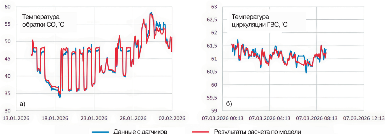
Рис. 1. Сравнение данных, полученных с датчиков температуры тестового МКД и рассчитанных по ММ: а – температура обратного теплоносителя в СО, б – температура циркуляции ГВС
