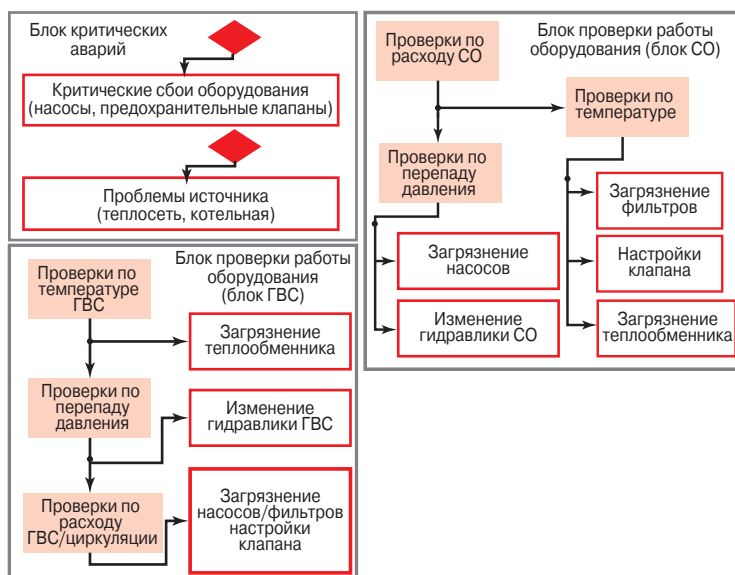
■ Рис. 3. Алгоритм локализации отклонений в блоках СО и ГВС на основании данных датчиков и результатов расчета по модели
