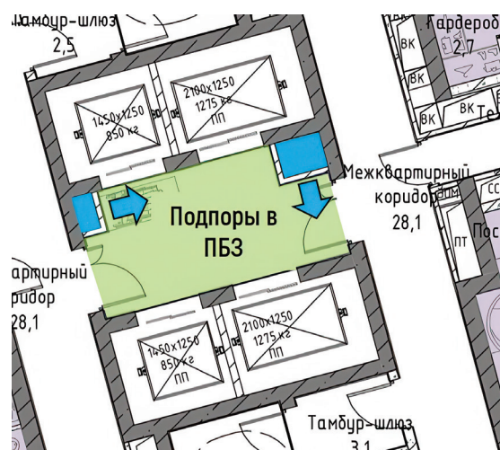
■ Рис. 15. Две шахты подпора воздуха в пожаро-безопасную зону – на закрытую дверь (малая шахта) и на открытую дверь (большая шахта)
