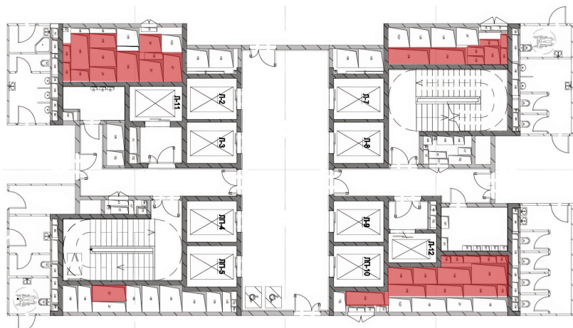
Рис. 2. Шахты с транзитными воздуховодами (планировка стадии «концепция», поэтому не показано монтажное пространство между воздуховодами). Цветом выделены воздуховоды «второй линии», к которым даже при наличии лючков невозможно добраться без демонтажа воздуховодов «первой линии»
