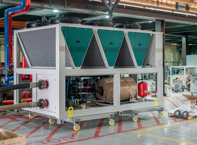
■ Тестирование холодильной машины (чиллера) на испытательном стенде
