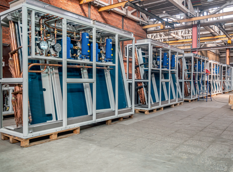
■ Выпуск верхнего модуля шкафов кондиционеров для ЦОД
