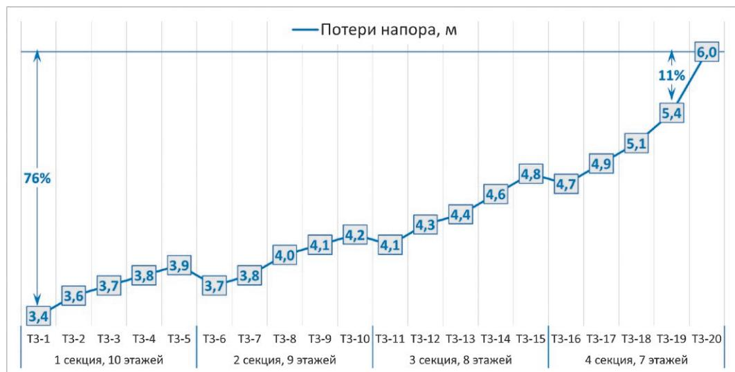
Пример результата гидравлического и теплового расчета
