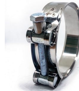
■ Рис. 4. Силовые хомуты из нержавеющей стали Робусты: стандартное исполнение W2; усиленные хомуты W4. Шарнирный нержавеющий хомут работает благодаря перемычке, которая образует шарнир между двумя участками ленты. В свободном состоянии перемычка удерживает стяжные элементы относительно друг друга и позволяет приводить вторые концы участков ленты ближе друг к другу
