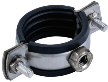
■ Рис. 1. Трубные хомуты из нержавеющей стали. Предназначены для крепления труб к строительному основанию. Такие хомуты снабжены прокладками для снижения шума и вибраций. Прокладки могут быть из резины EPDM, резины, силикона, каучука или другого материала для конкретных условий использования
