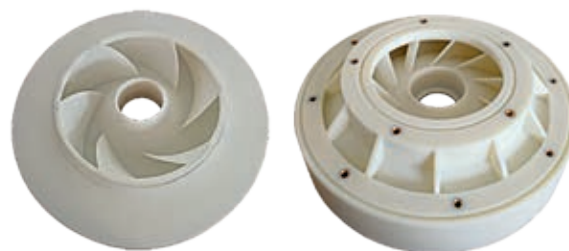
Рис. 5. Элементы проточной части насосов CDM, выполненные методами 3D-печати
