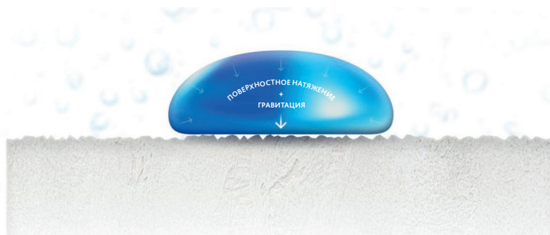
Рис. 2. Форма капли воды на поверхности твердого вещества
