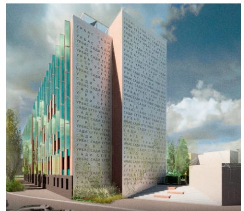
Рис. 7. Светоотражающая алюминиевая перфорация на юго-восточном фасаде (авторы визуализации И. Пушкарёва, М. Сидоровичев, И. Лернер, руководитель – доцент Е. Сухина)
