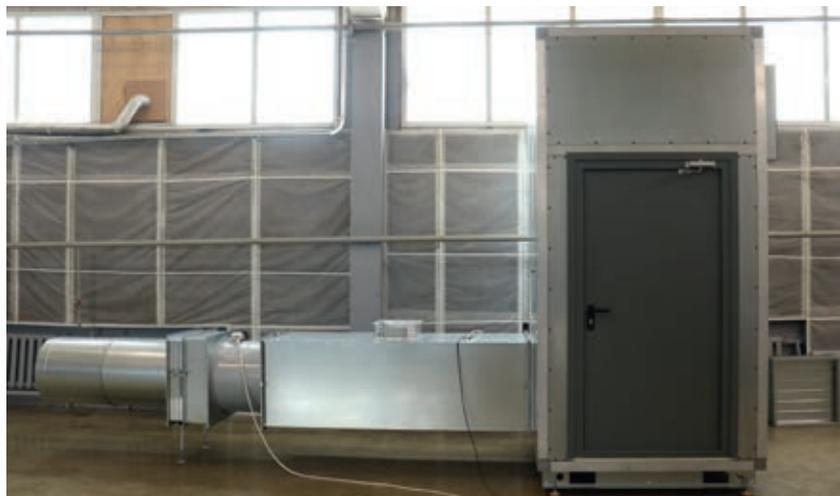
■ Изучение работы предохранительных клапанов разных конструкций на лабораторном стенде
