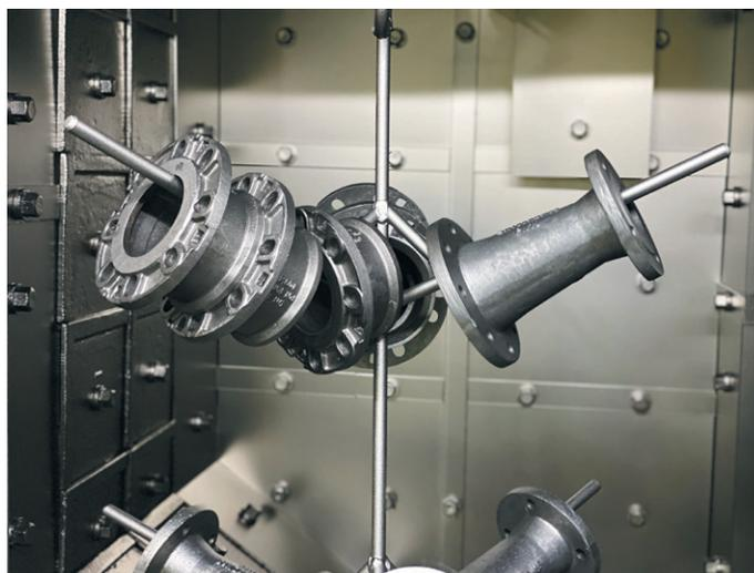
проводить испытания до восьми единиц продукции одновременно. Стенды позволяют испытывать трубопроводную арматуру на давление до 24 бар. Вся продукция, проходящая контроль, соответствует классу герметичности А по ГОСТ 9544-2015. На этом же участке нашего производства проводятся и циклические испытания (наработки «на отказ» путем проверки ресурса циклов открытия-закрытия у оборудования).
