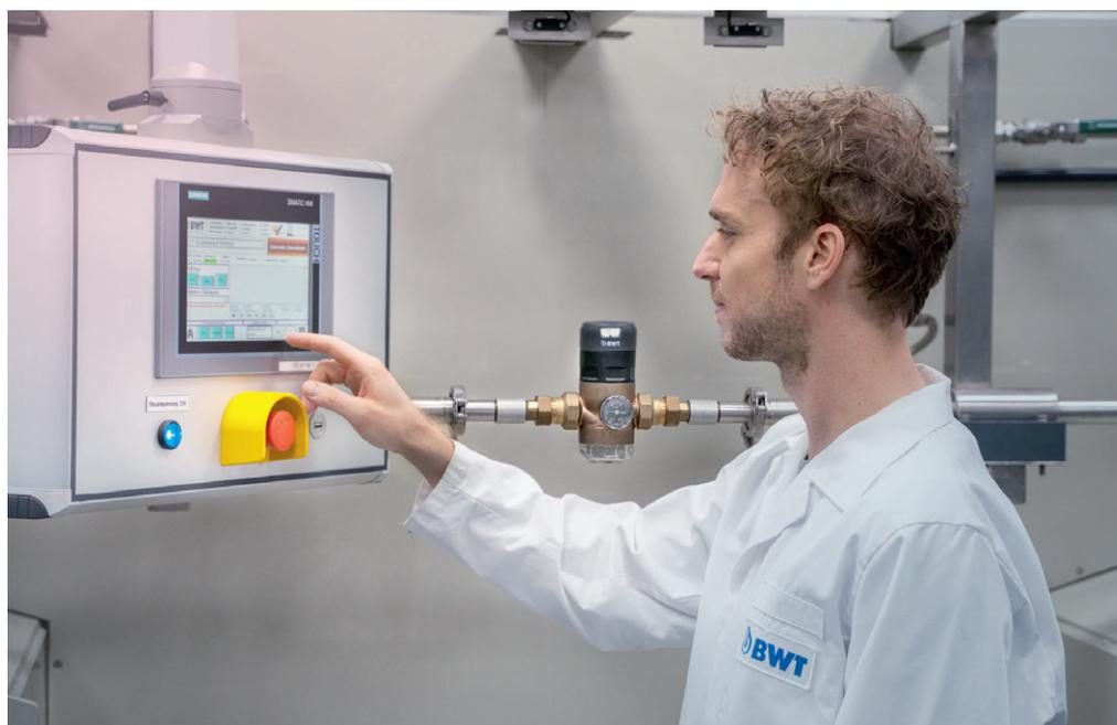
Данные редукторы предназначены для работы при температуре холодной воды до 40 °С или горячей воды до 85 °С.
