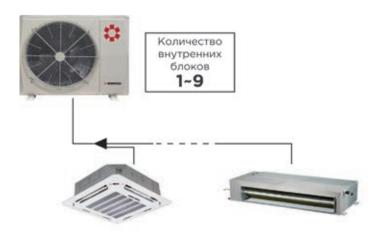
к данной системе, внутренних блоках. В линейке присутствует 6 типов в размерной линии от 2,2 до 16 кВт. Настенные, однопоточные кассетные, четырехпоточные кассетные компактные, кассетные стандартные, средненапорные канальные и универсальные внутренние блоки максимально востребованы на рынке систем кондиционирования.
