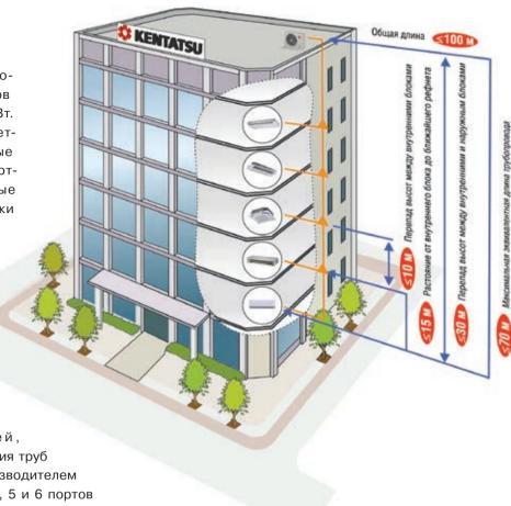
BMS. Можно управлять системой не только с современных индивидуальных пультов управления, но и с Touch-панелей КСС-50 или использовать популярное решение для подключения к BMS с помощью протокола MODbus.
