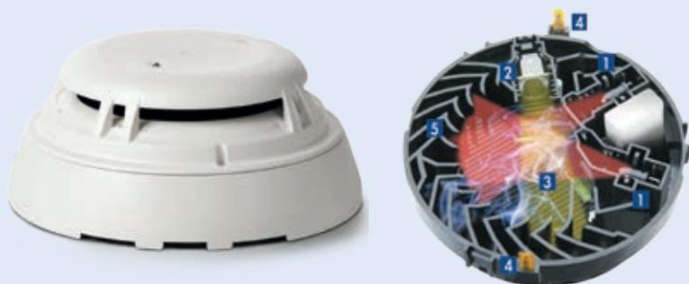
■ Рис. 1. Извещатель OON740: 1 – два инфракрасных излучателя, 2 – фотоприемник, 3 – дымовая камера, 4 – два тепловых сенсора, 5 – светопоглощающий лабиринт
