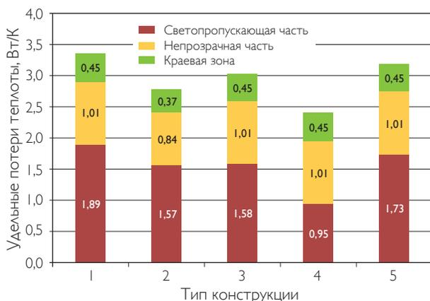
Рис. 2. Удельные потери теплоты через окна и их элементы
