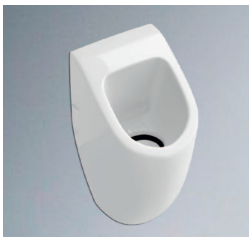
Рис. 3. Писсуар с широким сливным отверстием 7517 00 XX (коллекция Subway, бренд Villeroy & Boch, Германия). Материал – сантехнический фарфор с грязеотталкивающим покрытием segeticplus. Благодаря особой конструкции сифона писсуар можно использовать без подключения воды. Размеры: 53,5×30,5×35 см
