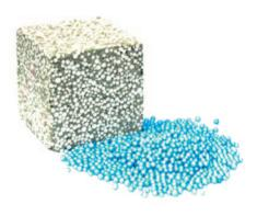
смеси — полистиролбетон. Полистиролбетон применяется для утепления полов, кровель, перекрытий новых и реконструируемых зданий, изготовления полистиролбетонных блоков разной плотности и типоразмеров.
