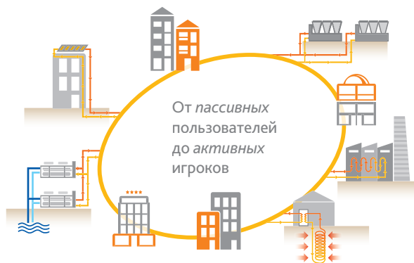
■ Рис. 4. Среднетемпературный контур теплоснабжения
