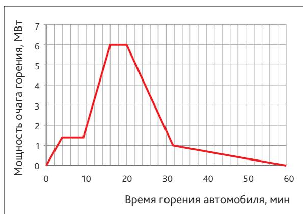
■ Рис. 4. График временной зависимости мощности очага горения при пожаре одного автомобиля
