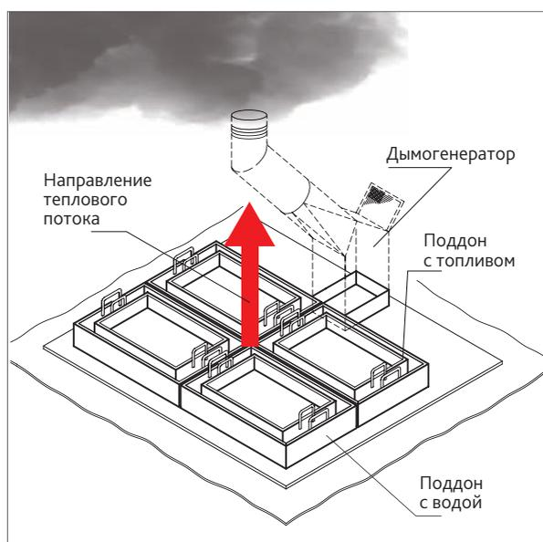
■ Рис. 3. Принципиальная схема установки для проведения испытаний горячим дымом
