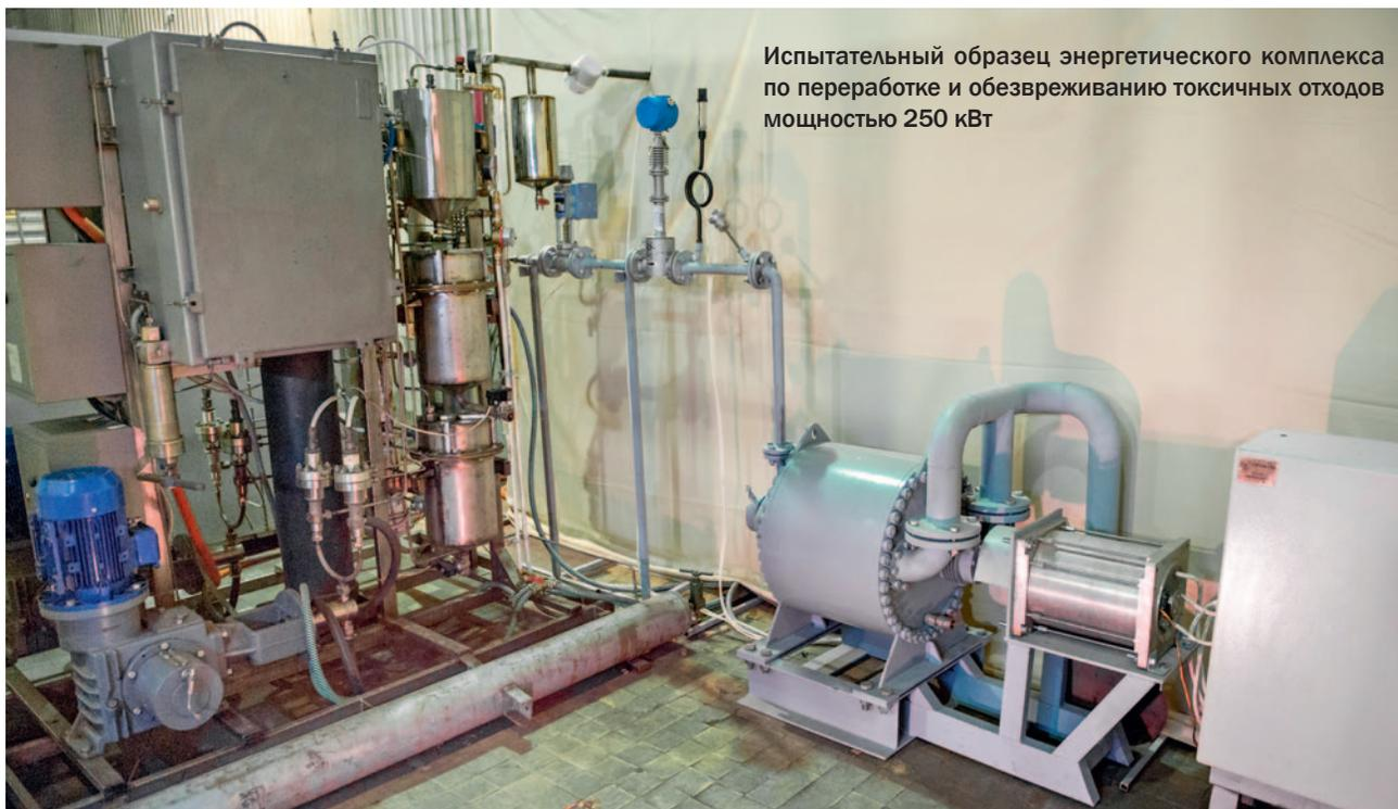
Испытательный образец энергетического комплекса по переработке и обезвреживанию токсичных отходов мощностью 250 кВт
