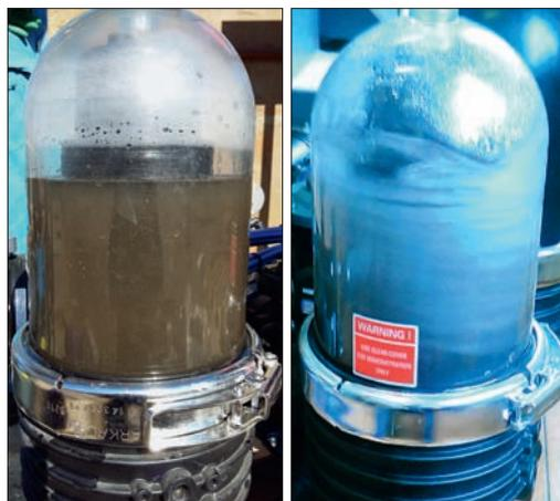
Рис. 3. Фильтрация и промывка в прозрачной колбе
