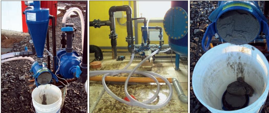
Рис. 1. Проведение пилотных испытаний на гидроциклонах
