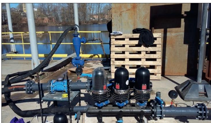
Рис. 2. Проведение пилотных испытаний «гидроциклон + дисковый фильтр»
