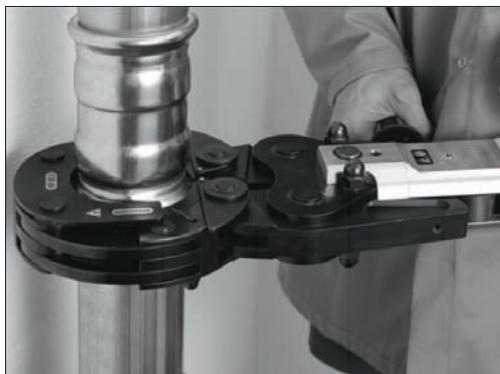
стоимость за услуги (часовая оплата квалифицированного рабочего выше) напрямую зависит от времени, затрачиваемого на проведение работ. При использовании инструмента соединение возможно сделать за несколько секунд, а сварка трубы производится 5–10 минут. Возьмем для примера 108-й диаметр, приведена была такая статистика: полное соединение по пресс-фитингам занимает 45 секунд, два подхода по 45 секунд, а чтобы такую трубу заварить, надо где-то минут 45 и более. Это существенное отличие.
