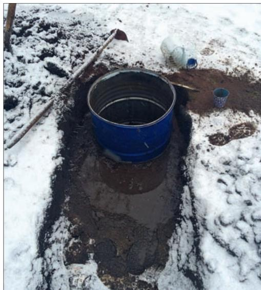
**Рис. 7.** Попытка экранировать приямок от талых вод путем установки вдавленной в грунт бочки без дна для замера оказалась неудачной – на следующий день шурф был практически полностью залит водой, включая и пространство внутри бочки
