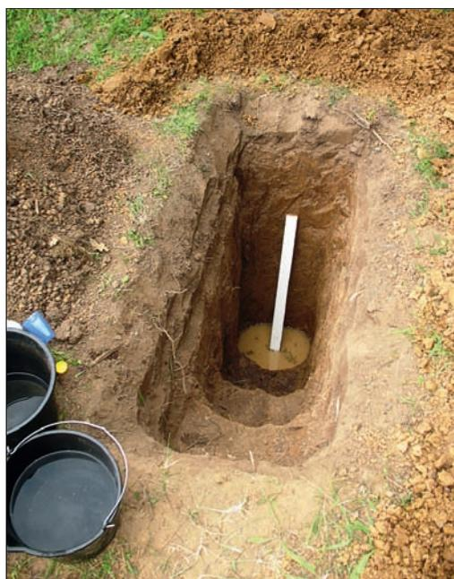
Рис. 4. Шурф для замера коэффициента фильтрации грунта
