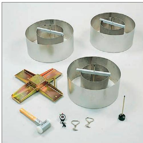
Рис. 2. Двухкольцевой инфильтрометр для замера фильтрующей способности грунта по ГОСТ 23278
