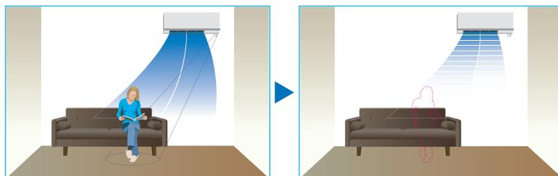
■ Рис. 2. Определение присутствия людей в помещении
