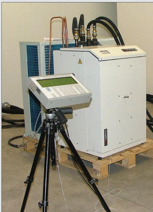
■ Рис. 1. Двухтемпературный тепловой насос «вода – вода» для применения в жилых и небольших коммерческих зданиях
