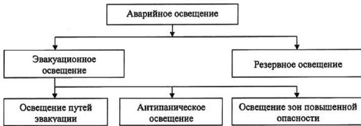
Рисунок 7.1 - Виды аварийного освещения
