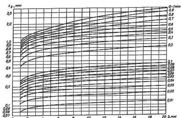
Рисунок Б.1 - Номограмма для определения эквивалентного размера протяженных объектов различия при расстояниях от глаза до объекта до 500 мм
