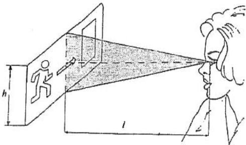
**Рисунок В.1 - Определение расстояния распознавания знака безопасности**
