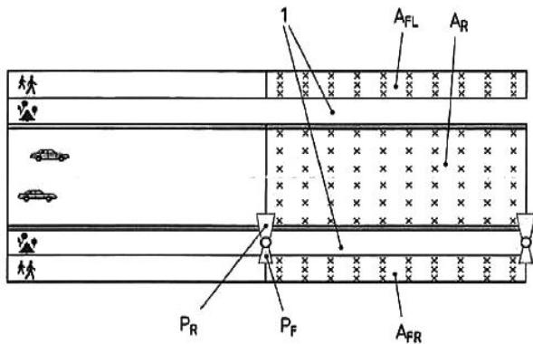
$A_R$ ,  $A_{FL}$  и  $A_{FR}$  - элементы расчетного поля: проезжая часть, левый и правый тротуары улицы соответственно;  $P_R$  и  $P_F$  - светильники, направленные на проезжую часть и правый тротуар соответственно; 1 - полосы газона; "x" - расчетные точки на расчетном поле
