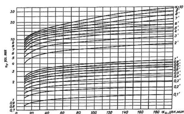
**Рисунок Б.2 - Номограмма для определения эквивалентного размера протяженных объектов различия при расстояниях от глаза до объекта более 500 мм**
