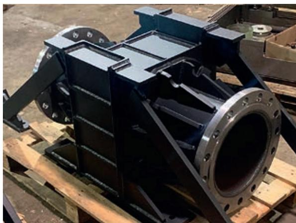
■ Рис. 3. Пример изделия «Опора неподвижная Ду300» на рабочую нагрузку 20 т (производитель ООО «ТПК Арекс»)
