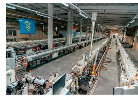
высокие стандарты на всех этапах организации производства. Передовое оборудование ведущих брендов: KraussMaffei – экструзионные линии для производства труб, Haitian – термопластавтоматы для производства фитингов, сырье крупнейшего нефтехимического холдинга «Сибур», использование цифровых технологий и контроль качества на каждом этапе технологического цикла при производстве, хранении и отгрузке продукции.
