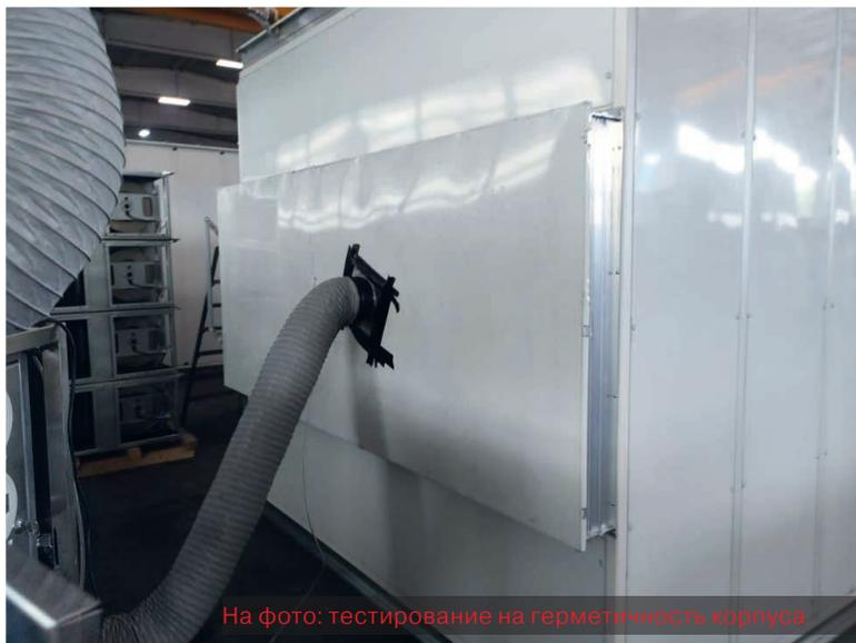
На фото: тестирование на герметичность корпуса
