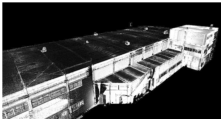
■ Рис. 1. Пример результатов 3D-сканирования существующего предприятия
