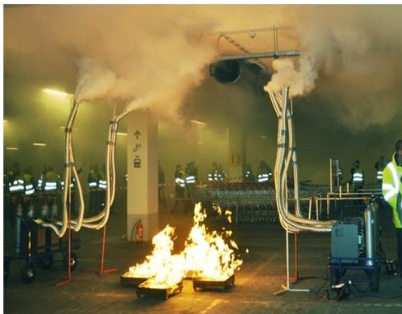
Рис. 7 Испытания горячим дымом в автостоянке с потолком высотой 5 м.
