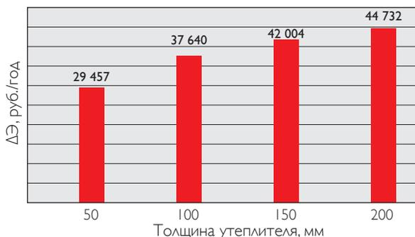
Рис. 3. Величина годовой экономии денежных средств, руб./год, достигаемая в результате утепления наружных стен деревянного дома при различной толщине утеплителя (50, 100, 150, 200 мм)
