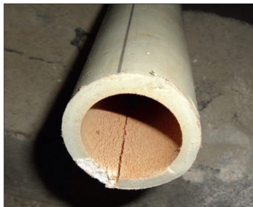
Рис. 3. Разрыв полипропиленовых труб
