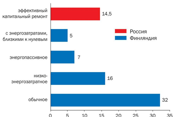
**Рис. 7.** Сравнение удельного расхода тепловой энергии на отопление и вентиляцию здания за отопительный период, кВт·ч/(м³·год), в России и Финляндии
