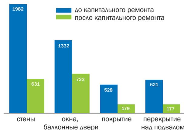
Рис. 4. Удельные тепловые потери, Вт/К, через ограждающие конструкции
