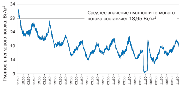
Рис. 4. Значения средней плотности теплового потока через испытываемую конструкцию стены за период наблюдений
