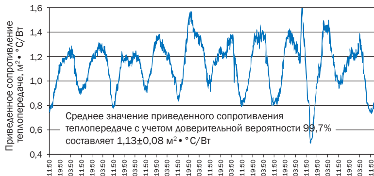
Рис. 5. Значения приведенного сопротивления теплопередаче стены за период наблюдений
