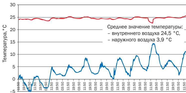
Рис. 3. Значения температуры внутреннего и наружного воздуха за период наблюдений, °C
