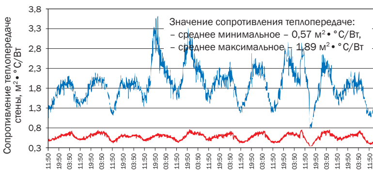
Рис. 6. Сопротивление теплопередаче стены в зонах минимальных и максимальных значений за период наблюдений
