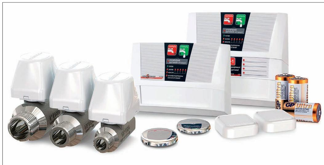
срабатывания датчика достаточно небольшого количества воды. Контроллер, в свою очередь, передает сигнал на краны для их перекрытия. Если говорить конкретно о нашей системе, то весь процесс занимает три секунды. При этом использование шаровых кранов исключает гидроудар из-за постепенного, не резкого перекрытия крана.
