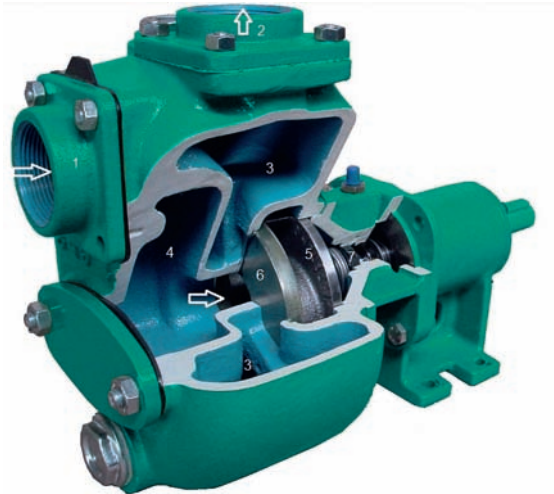
Рис. 4. Самовсасывающий насос: 1 – входной патрубок с обратным клапаном, 2 – выходной патрубок, 3 – камера рециркуляции, 4 – входная камера, 5 – рабочее колесо, 6 – накладная пластина, 7 – торцевое уплотнение
