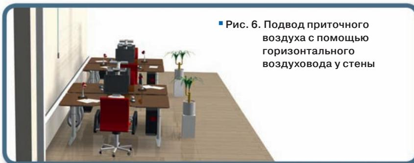
■ Рис. 6. Подвод приточного воздуха с помощью горизонтального воздуховода у стены
