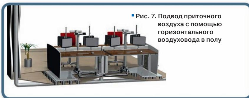
■ Рис. 7. Подвод приточного воздуха с помощью горизонтального воздуховода в полу
