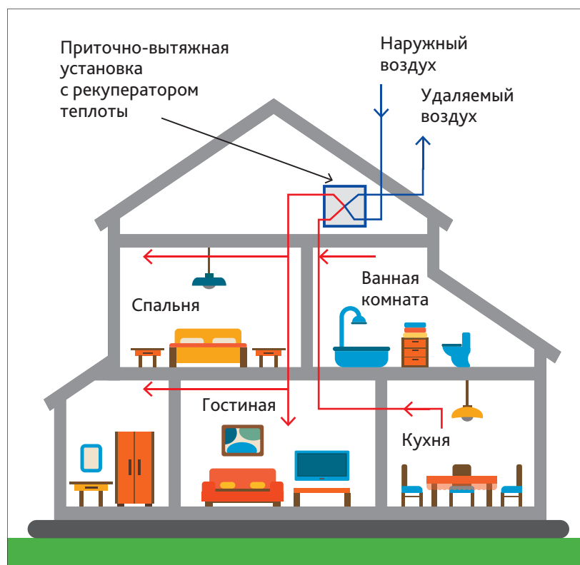
■ Рис. 1. Принципиальная схема механической вентиляции с рекуперацией теплоты вытяжного воздуха в индивидуальном жилом доме
