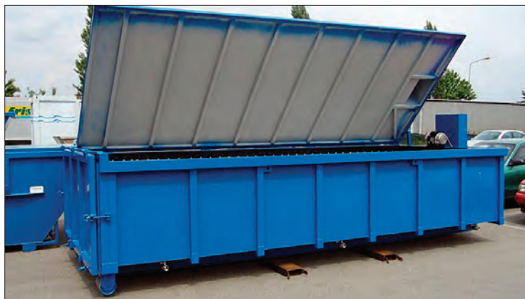
Рис. 4. Шламоосушающий контейнер роликового типа с открытой крышкой
