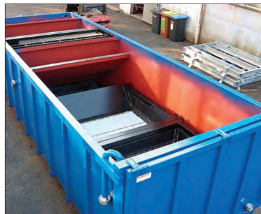
Рис. 5. Контейнер с внутренним переливом, ламельным блоком и системой для сбора шлама
