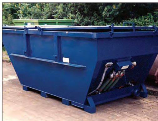
Рис. 2. Аэрируемый шлагоосушающий контейнер с верхней фиксирующейся крышкой
