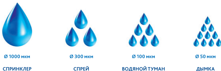
Рис. 1. Сравнение размера капель обычной и распыленной воды
