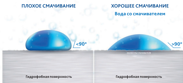
Рис. 3. Форма капли воды со смачивателем на поверхности твердого вещества и эффективность смачивания
