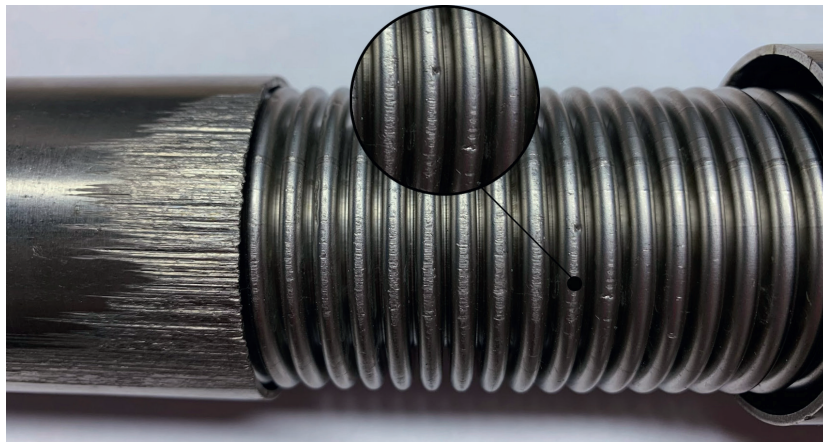
■ Задир и зазубрины, возникшие от соприкосновения с торцом телескопического кожуха в ходе испытаний компенсаторов «Хортум»
