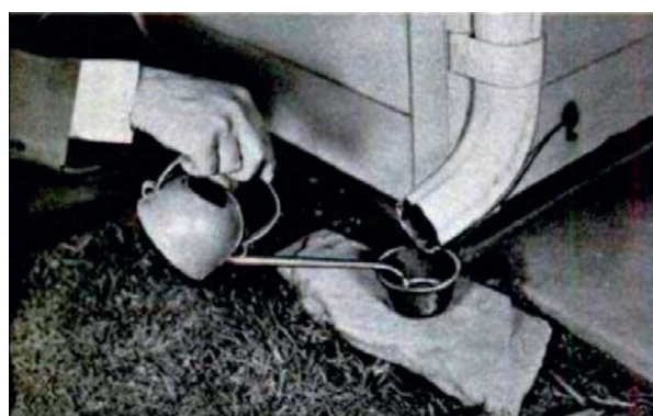
Рис. 2. Система закрывания окон при дожде
