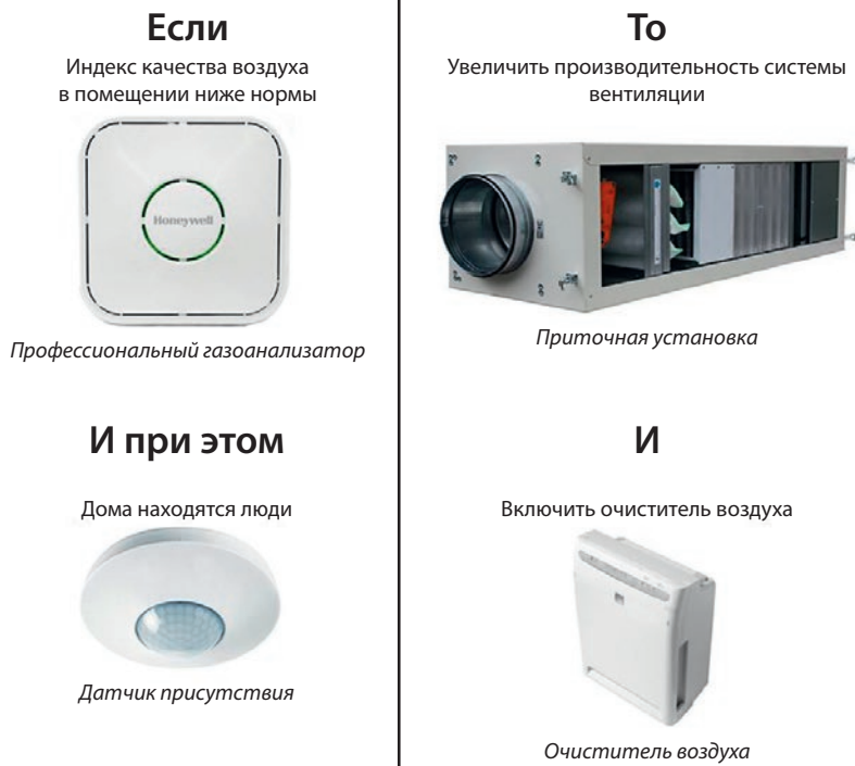
Рис. 6. Сценарии умного дома довольно просты и построены по принципу «если, то». В данном случае профессиональный газоанализатор определяет качество воздуха дома по уровню CO, летучих органических соединений, взвешенных частиц и т. п. и при наличии людей, определяемому по датчику присутствия (а не более грубому датчику движения), командует вентиляцией и очистителем
