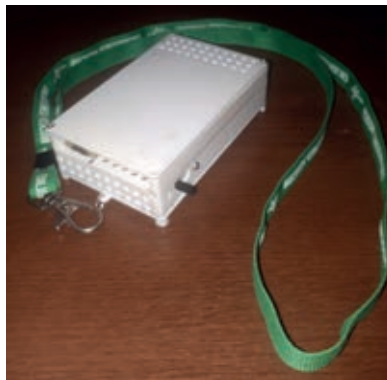
■ Рис. 5. Миниатюрный индивидуальный ионизатор
