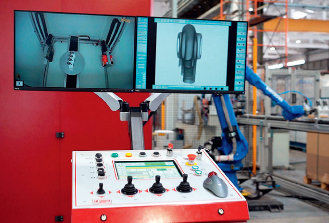
Рентгенографический контроль сварных швов на заводе АО «РИФАР»
