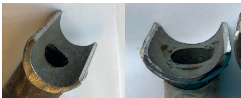
■ Рис. 6. Варианты изготовления замыкающих участков биметаллического радиатора
