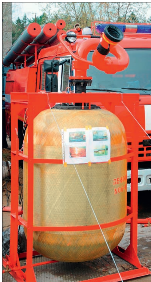
Рис. 3. Установка УПАТ-2000 с лафетным стволом
